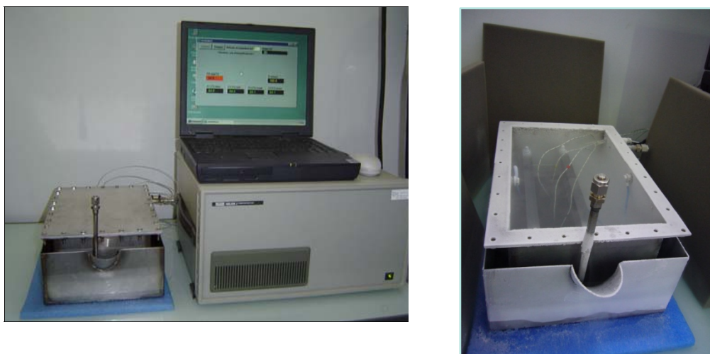
Figure III- 14 Schéma et montage expérimental de l'étude par effet Joule (-120 °C – 30 °C)
